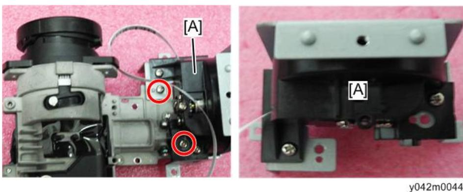
4. 拆除两颗螺丝，以拆除色轮[A]。
