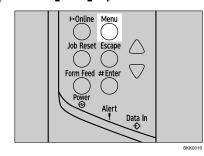
Press the 【▼】 or 【▲】 key to display [Host Interface], and then press the 【# Enter】 key.
