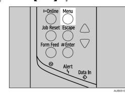
Press the 【▼】 or 【▲】 key to display [Host Interface], and then press the 【# Enter】 key.
