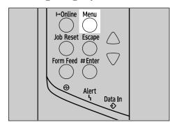
Press the 【▼】 or 【▲】 key to display [Host Interface], and then press the 【# Enter】 key.
