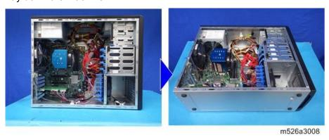
3. Lift the CPU fan bracket.
