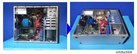
3. Lift the CPU fan bracket.
