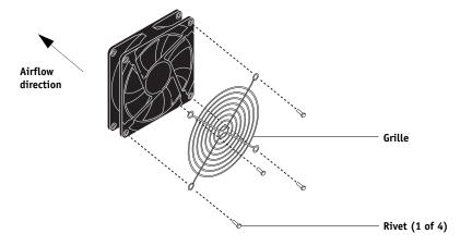
FIGURE 46: Installing the fan grille
