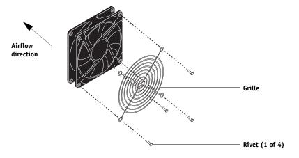
FIGURE 46: Installing the fan grille
