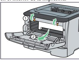
BXG014 | 5. Retire el material protector colocado en el interior de la impresora.<br>
