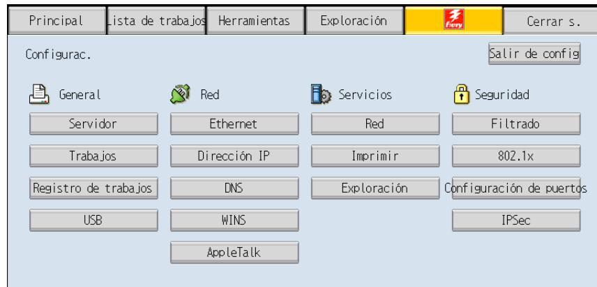
Si la red utiliza DHCP, el Pro C900s obtiene automáticamente la dirección IP. En caso contrario, escriba la dirección del Pro C900s.
